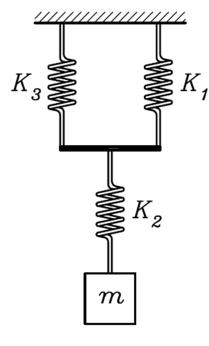
بنابراین، مطابق شکل رو برو، فنر معادل فنرهای  $k_1$  و  $k_3$  با فنر  $k_2$  به صورت سری قرار خواهد گرفت.
