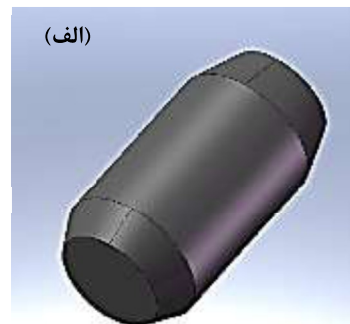
شکل ۱-۵- تصویر نمادین از ماهیچه‌های مورد استفاده در طرح فولاد قبل از مونتاژ.
