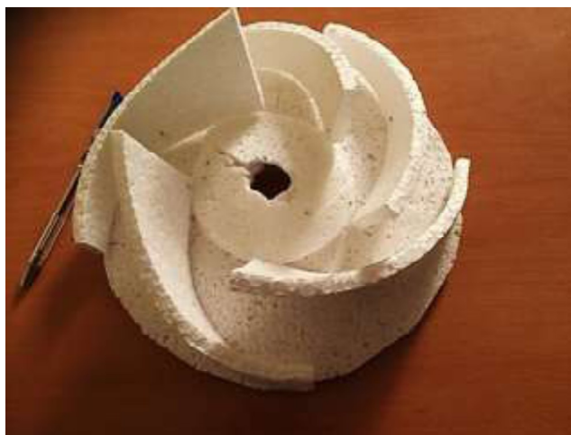
شکل ۱-۱۳- مدل یونالیتی مربوط به طرح فولاد.
