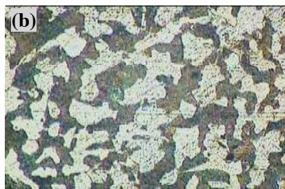
شکل ۱-۱۲- تصویر میکروسکوپی از فولاد CK۴۵ (a) پس از ریخته‌گری، (b) پس از عملیات حرارتی با بزرگنمایی ۲۰۰ برابر.
