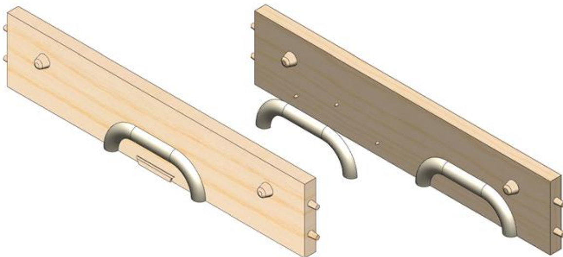
شکل 3-7 نحوه قرار گیری مدل پزیتیو بر روی صفحه چوبی.
