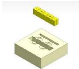
شکل 5: نحوه قرارگیری جعبه ماهیچه درون قالب
