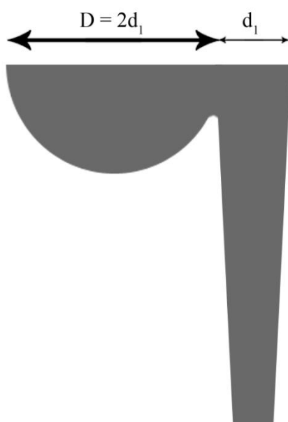
شکل ۲ - نسبت پیشنهاد شده توسط منابع بین قطر بالایی راهگاه بارریز و قطر حوضچه بارریز
