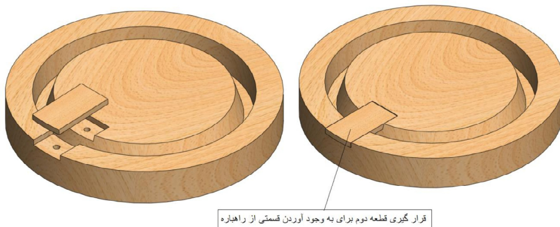
شکل 30. جعبه ماهیچه طراحی شده برای ساخت ماهیچه پیرامون . ( جعبه ماهیچه دو تکه می باشد )
