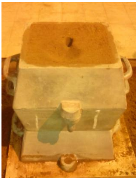
شکل ۳-۵. قالبگیری درجه سوم و تعبیه حوضچه بارریز
