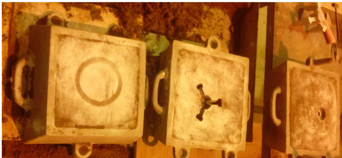
شکل ۳-۶. خارج کردن مدل از درجه ها
