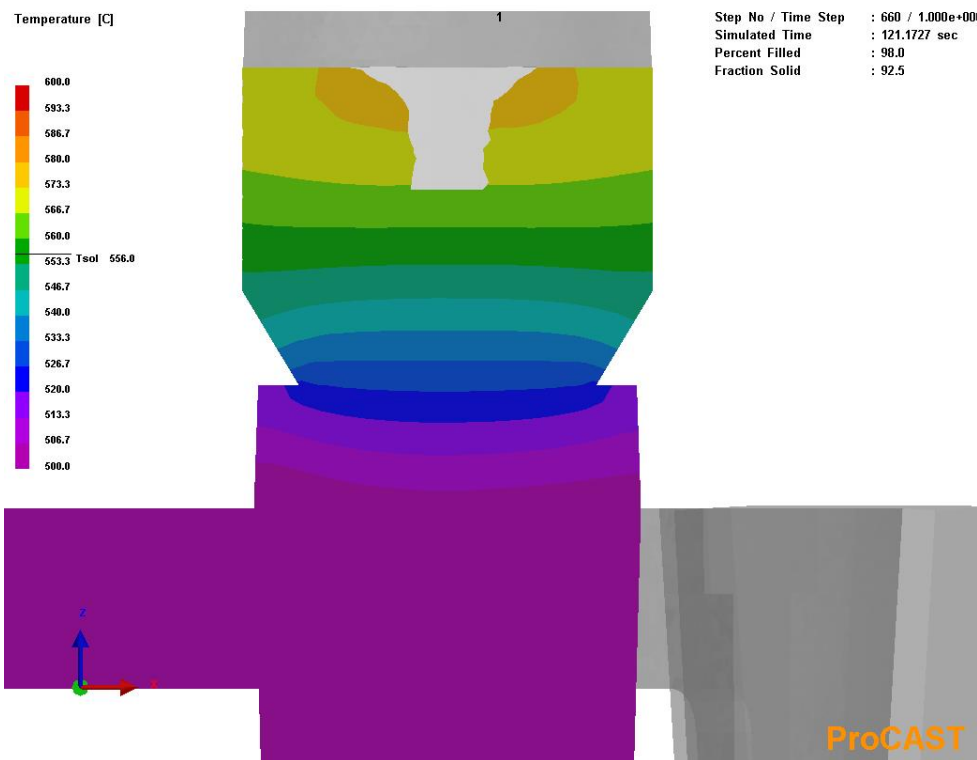
شکل ۲-۲۸. شیب دمایی در سه منطقه قطعه، گلولی و تغذیه.
