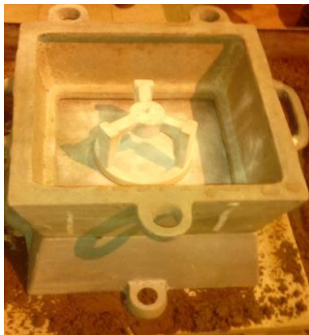
شکل ۳-۲. نحوه قرار گیری مدل درون درجه دوم
