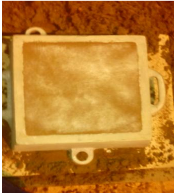
شکل ۳-۱. قالبگیری درجه اول
