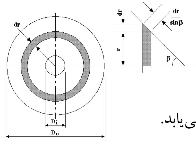
با کاهش زاویه  $\beta$ ، مقدار تورک افزایش می یابد.
