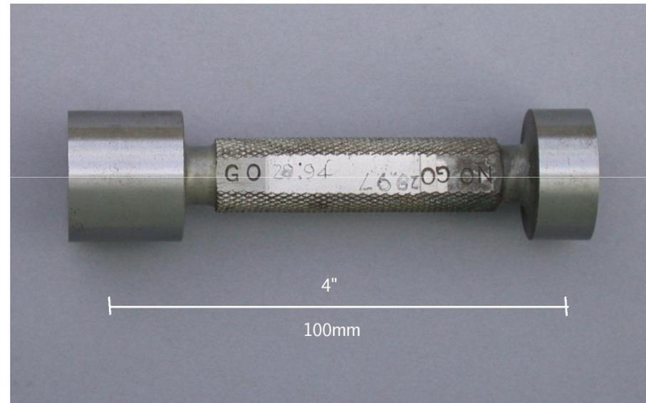
قطر 29.94 باید عبور کند و قطر 29.97 نباید عبور کند. اگر هر دو عبور کردند از ماکزیمم بیشتر است و اگر هر دو عبور نکردند از مینیمم کمتر است. در اینجا مقادیر ماکزیمم و مینیمم حذف شده‌اند.
