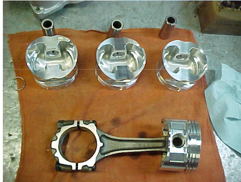
قسمتی از گلنپین، بر روی ته دسته شاتون و بقیه آن بر روی پیستون تکیه دارد (سه تکیه‌گاه وجود دارد). با فرض سوراخ مینا، باید گلنپین دارای پله می‌شد.
