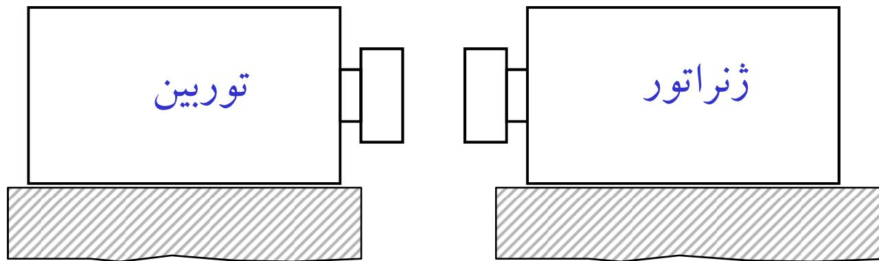
لقی بین اتصال دو نیمه کوپلینگ (در توربین و در ژنراتور) قابل قبول نیست.
