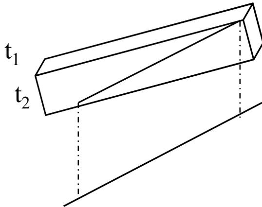
محدوده تفرانس بوسیله يك مكعب مستطیلی با مقطع  $t_1 \times t_2$  و موازی با خط مبنای مشخص می شود اگر تفرانس در دو صفحه عمود بر هم مشخص شده باشد.
