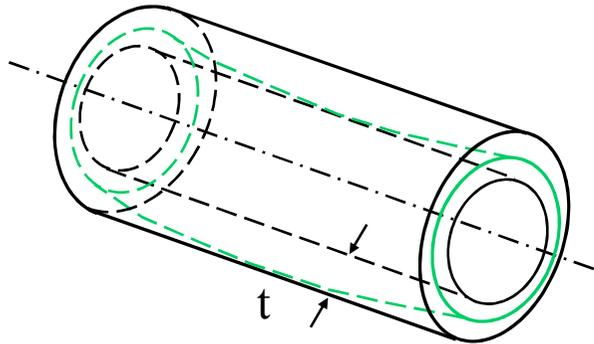
محدوده تفرانس بوسیله دو استوانه هم محور به فاصله  $t$  از هم مشخص می‌شود.
