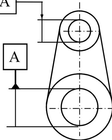
**مثال:** محور تفرانس باید در ناحیه دو خط راست به فاصله  $0.1\text{mm}$  که با محور مبنای  $A$  موازی هستند و در جهت عمودی است، قرار گیرد.
