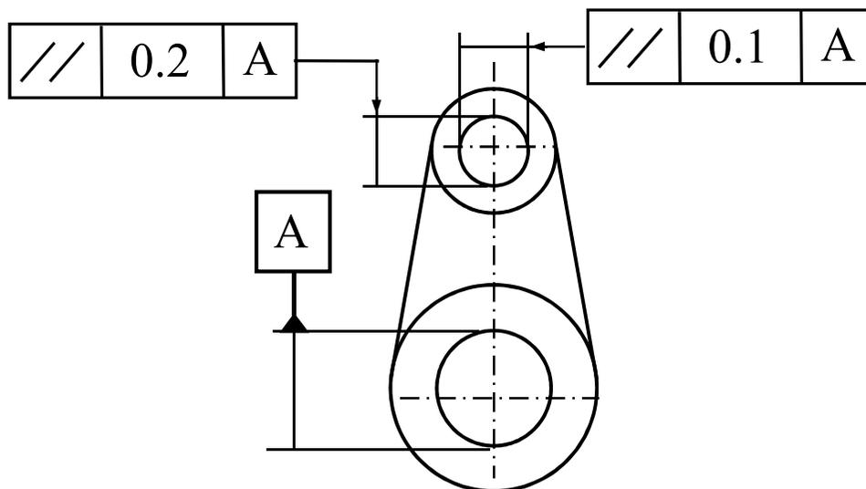
**مثال:** محور تفرانس گذاری شده باید در يك منطقه تفرانس مكعب مستطیلی با پهناي 0.1mm مقطع و پهناي عمودی 0.2mm قرار گیرد و با محور مبنای موازی باشد.
