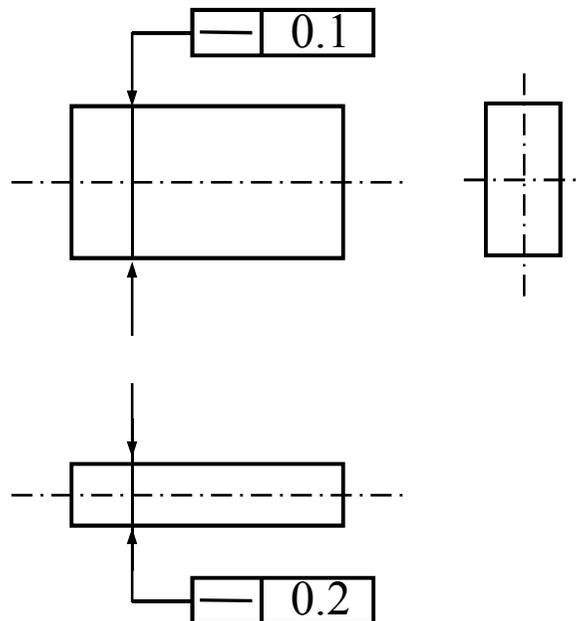
**مثال:** محور میله باید درون یک ناحیه مکعب مستطیل با پهنای عمودی 0.1mm و پهنای افقی 0.2mm قرار گیرد.
