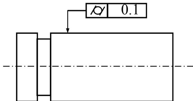
**مثال:** سطح مورد نظر باید بین دو استوانه هم مرکز به فاصله  $0.1\text{mm}$  از هم قرار داشته باشد.
