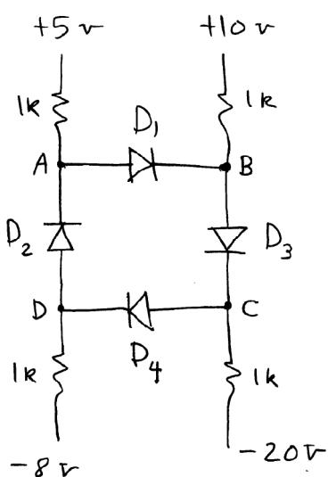
۳- در مدار شکل زیر حداقل دامنه سیگنال متقارن خروجی چند ولت است؟ ضریب تقویت و امپدانس
