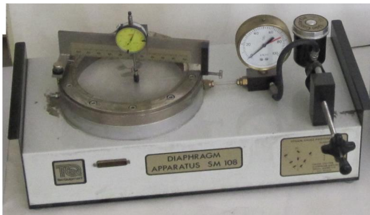
شکل ۵ وسیله اندازه گیری کرنش در دیافراگم (SM108) و اجزاء آن
